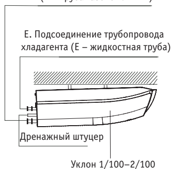
D. Подсоединение трубопровода хладагента (D – труба газовой линии)
