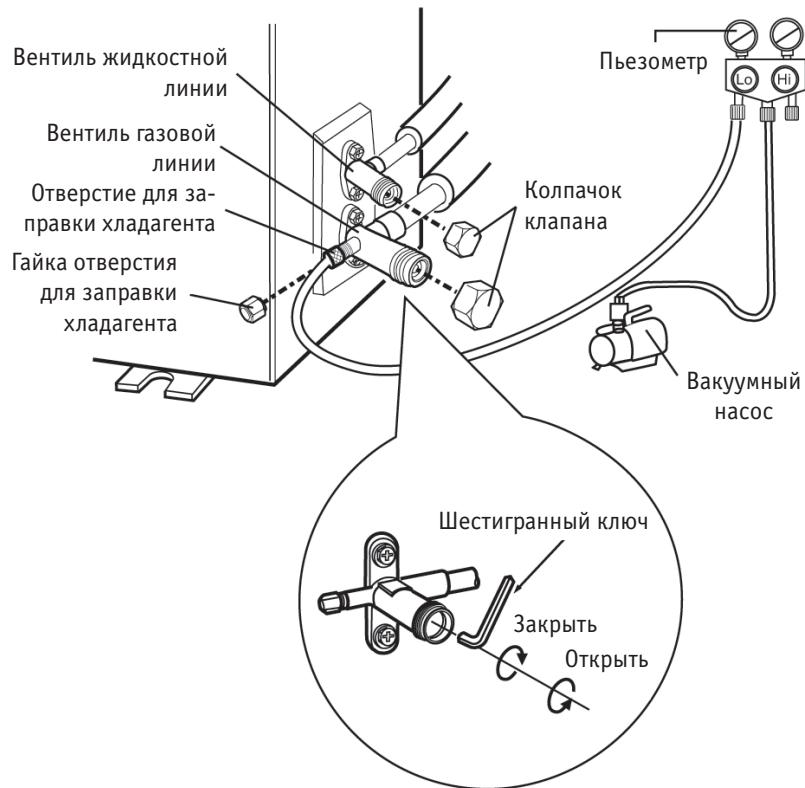
1. Снимите колпачки клапанов с клапанов жидкостной и газовой линий и гайку отверстия для заправки хладагента.
