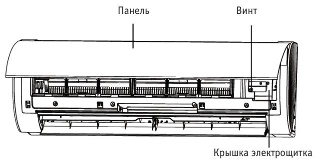
2. Пропустите кабель электропитания через предназначенное для него отверстие на задней стороне внутреннего блока и выведите его с передней стороны.
