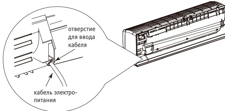
3. Снимите хомут; подсоедините провода кабеля электропитания к клеммам электрощитка, соблюдая цветность проводов; затяните винты и зафиксируйте кабель хомутом.
