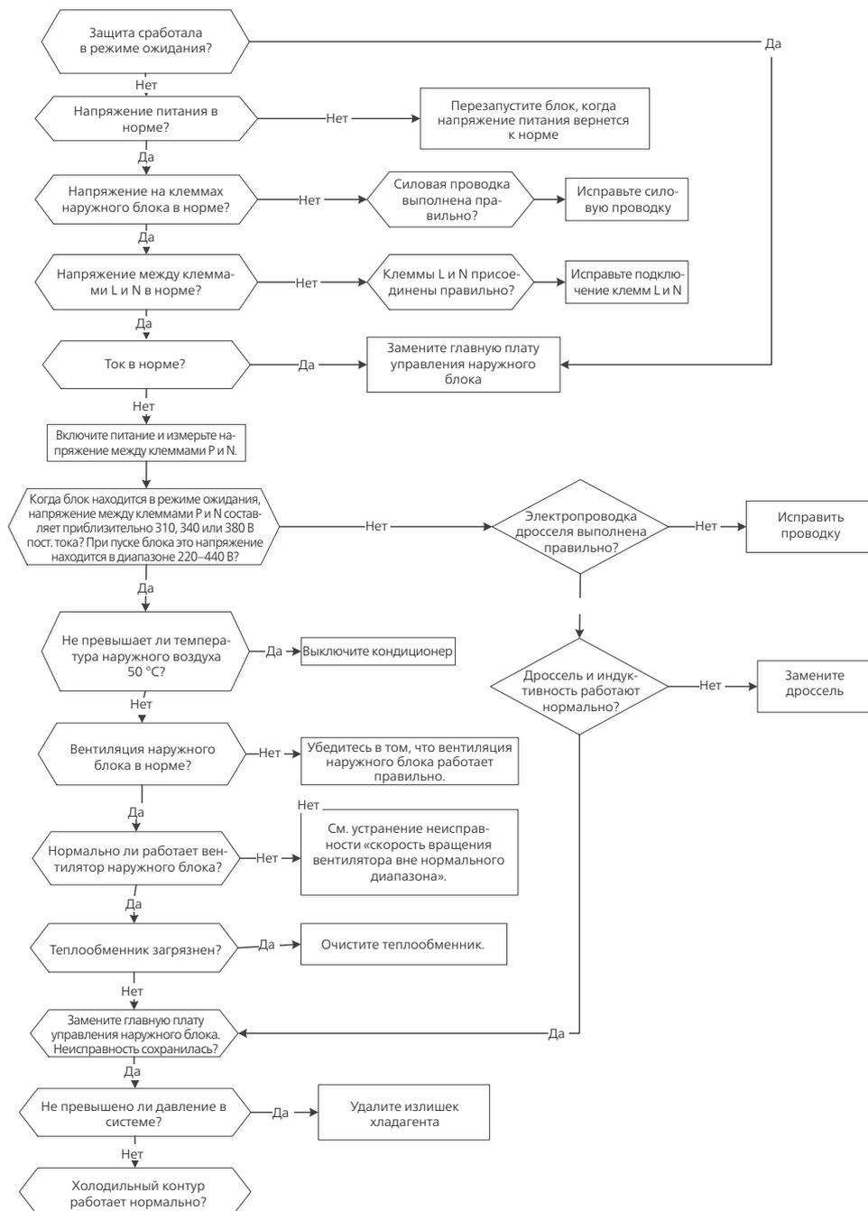
**Примечание:** У некоторых моделей печатную плату наружного блока нельзя снять отдельно. В этом случае необходимо заменить блок электрического управления наружного блока в сборе.
