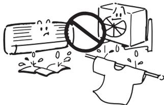
При работе наружного блока в режиме нагрева из него может капать вода.
