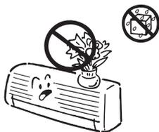
При попадании воды внутрь кондиционера возможно нарушение изоляции проводов, что чревато коротким замыканием или поражением электрическим током.
