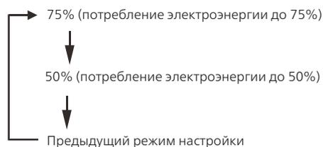
Данная функция прекращает действие при выключении кондиционера или активации функций ECO, Sleep, Super cool, Нагрев до 8°C, функции самоочистки, а также при включении малошумного режима.
