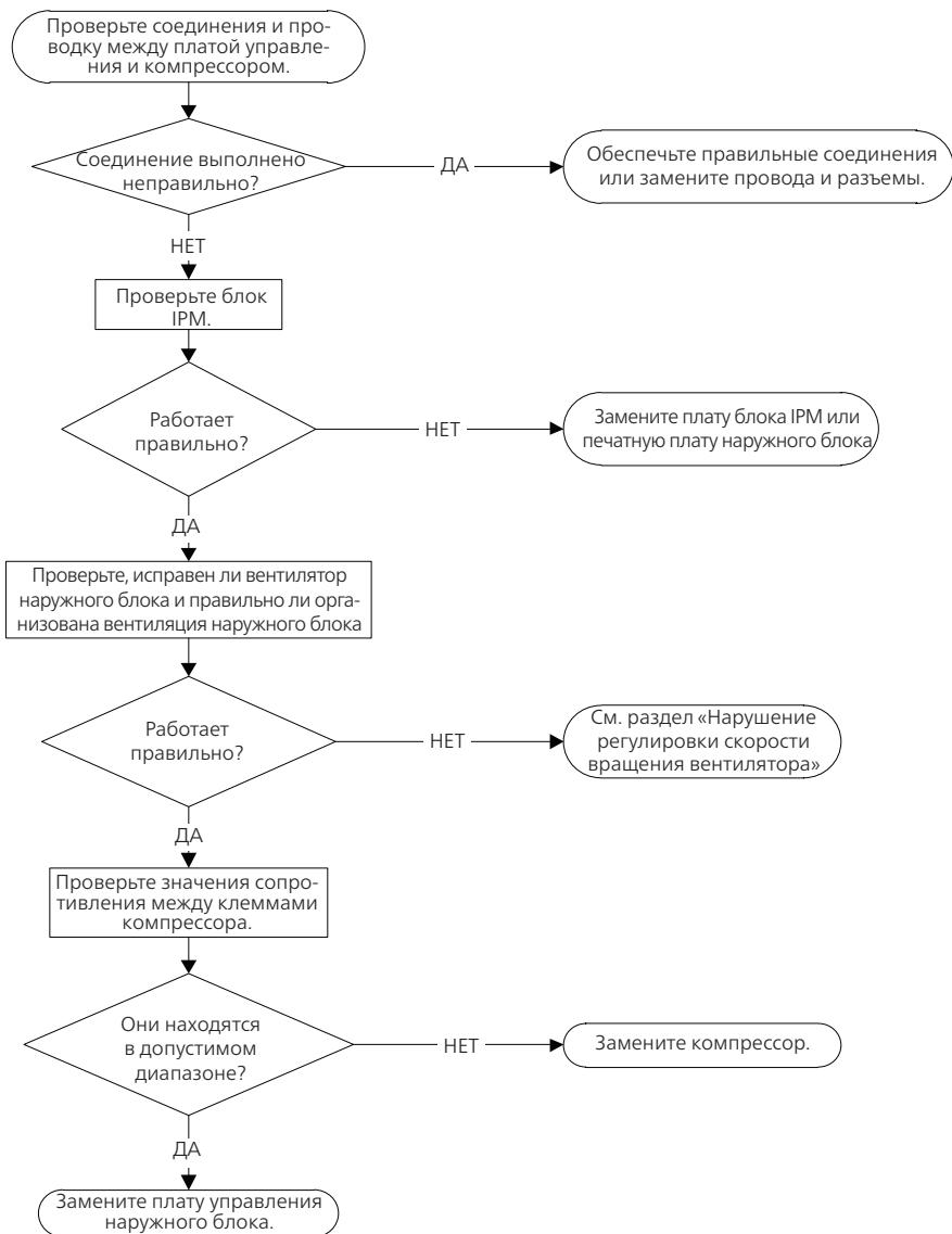
**Примечание:** У некоторых моделей печатную плату наружного блока нельзя снять отдельно. В этом случае необходимо заменить блок электрического управления наружного блока в сборе.
