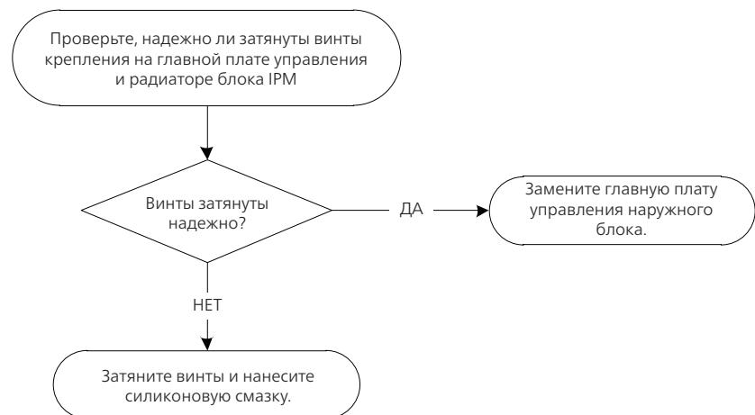
Примечание: У некоторых моделей печатную плату наружного блока нельзя снять отдельно. В этом случае необходимо заменить блок электрического управления наружного блока в сборе.
