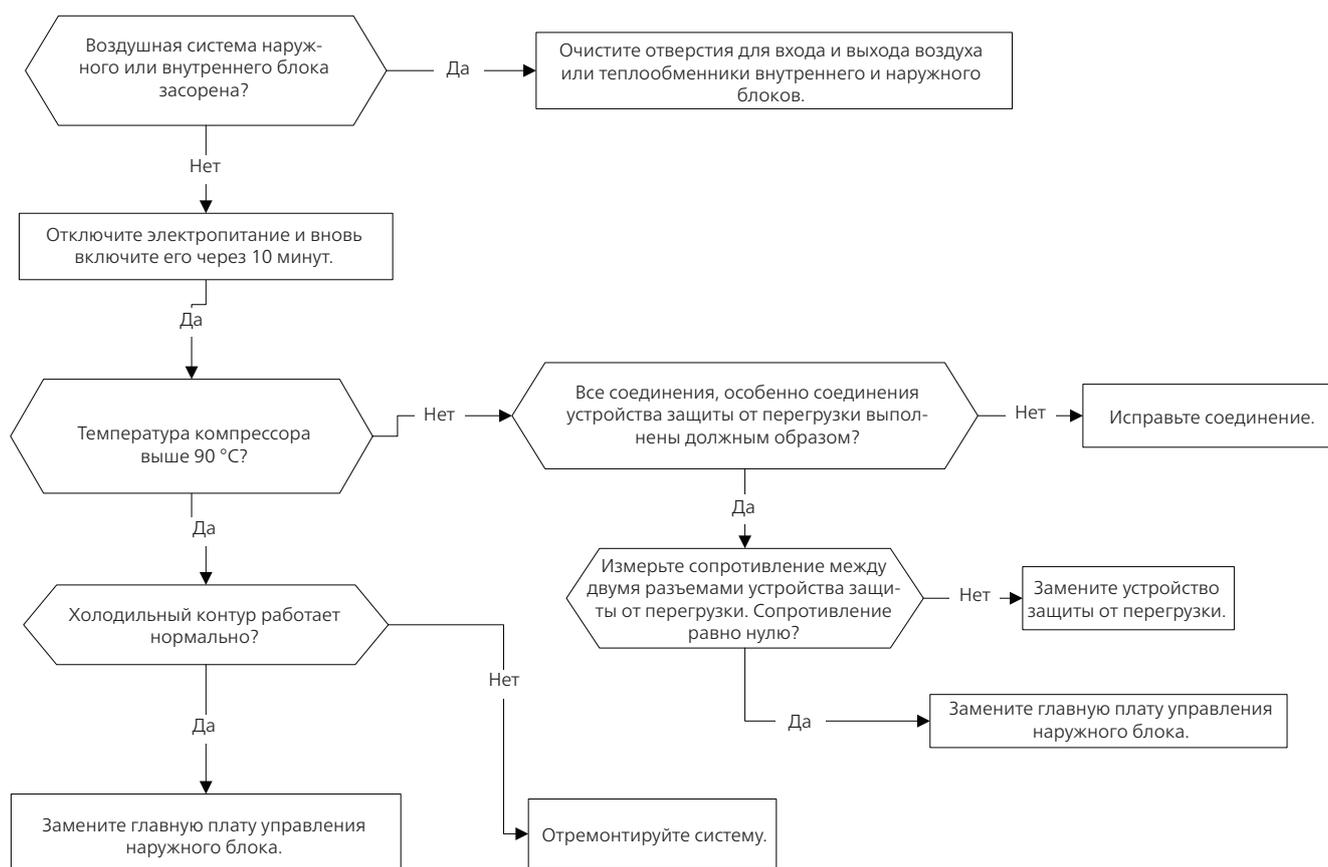
**Примечание:** У некоторых моделей печатную плату наружного блока нельзя снять отдельно. В этом случае необходимо заменить блок электрического управления наружного блока в сборе.
