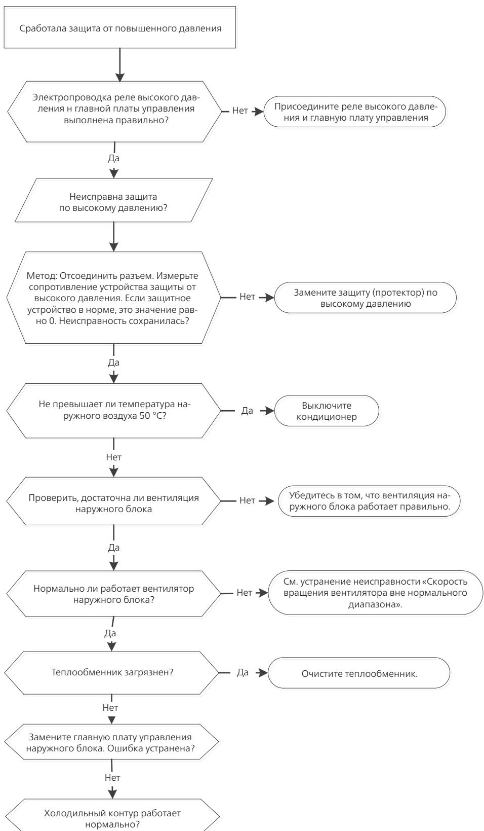
**Примечание:** У некоторых моделей печатную плату наружного блока нельзя снять отдельно. В этом случае необходимо заменить блок электрического управления наружного блока в сборе.
