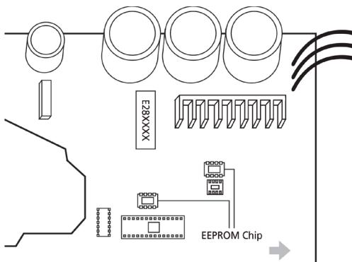
**Примечание:** У некоторых моделей печатную плату наружного блока нельзя снять отдельно. В этом случае необходимо заменить блок электрического управления наружного блока в сборе. Данные иллюстрации приведены только в качестве справочной информации, фактический внешний вид может отличаться.
