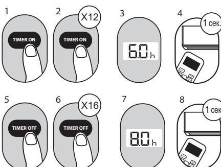
Например: установка таймера на включение через шесть часов работы, рабочее время два часа и затем автоматическое выключение (см. рисунок ниже).
