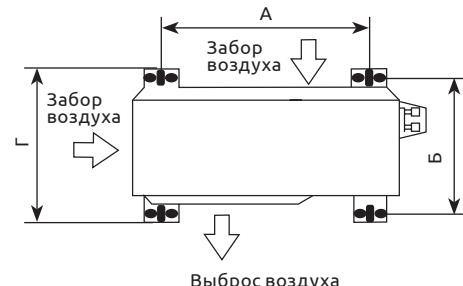
**ПРИМЕЧАНИЕ:** приведенные установочные размеры являются справочными и могут быть изменены без предварительного уведомления.
