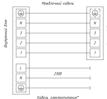
\*Кабель электропитания подключен к плате управления внутреннего блока
