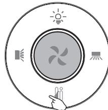
Данная функция позволяет дистанционно измерять температуру с помощью термодатчика в пульте управления и передавать эту информацию кондиционеру для поддержания комфортных условий в месте нахождения пользователя (пульта)
