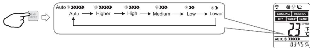
**i** В режиме FAN ONLY, режим AUTO (автоматический выбор скорости вентилятора) не доступен. В режиме DRY скорость вращения вентилятора устанавливается автоматически, и кнопка FAN SPEED не используется.
