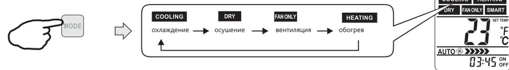
**i** Переключение между режимами кондиционера занимает определенное время. При включении кондиционера на режим нагрева, кондиционер тратит от 2 до 5 минут на разогрев теплообменника, после чего подует теплый воздух.
