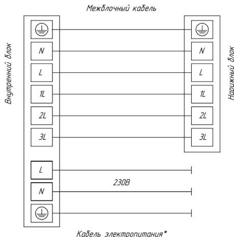
\* Кабель электропитания подключен к плате управления внутреннего блока
