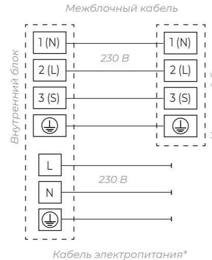
**Подключение электропитания и осуществление межблочных соединений**
