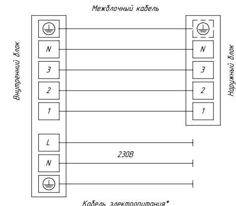
\*Кабель электропитания подключен к плате управления внутреннего блока
