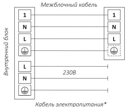
\* Кабель электропитания подключен к плате управления внутреннего блока блока
