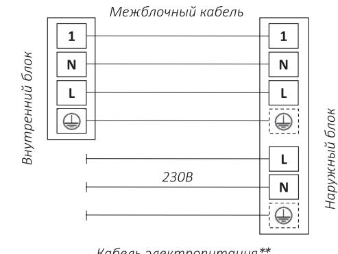
\*\* Кабель электропитания подключен к плате управления наружного блока блока
