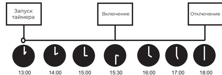
Таймер на включение через 2,5 часа
