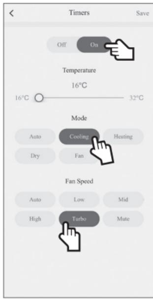
При установке таймера на включение вы сможете настроить такие параметры, как режим, температура и скорость работы вентилятора.
