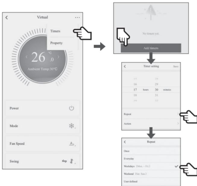
При нажатии на символ «...» в верхней части интерфейса управления вы откроете верхнее меню, в котором расположены таймер и свойства подключенным к приложению устройств. При нажатии на кнопку «Timers», вы перейдете к настройке таймера на включение/выключение кондиционера, где вы можете выбрать время включения/выключения устройства, так же настроить дни работы таймера (недельное расписание).
