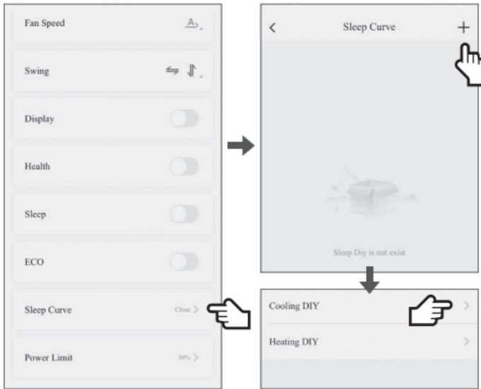
При нажатии на кнопку «**Sleep Curve**» запускается функция, позволяющая настраивать алгоритм работы кондиционера в ночное время, регулируя по времени температуру в помещении
