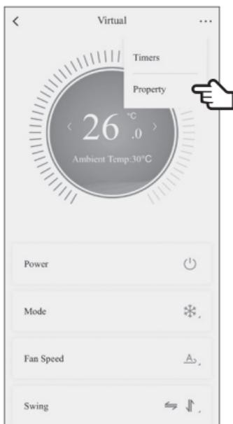
При нажатии кнопки «Property» вы перейдете в меню с данными всех подключенных устройств, так же в нем будет отражено местоположение каждого устройства (комната).
