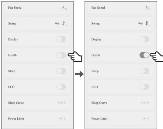
При помощи ползунков, находящихся с нижней части интерфейса управления вы можете так же включать/выключать дисплей внутреннего блока, активировать функцию Ионизации (если кондиционер к нему оснащен), режим комфортного сна, функцию ECO.
