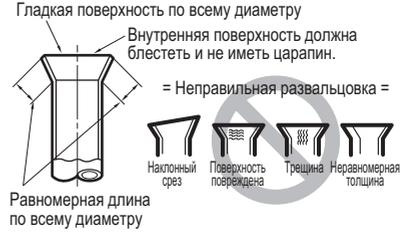
**Соединение трубопровода - Снаружи**
