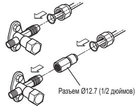
Затягивайте конусную гайку динамометрическим ключом, пока ключ не щелкнет.
