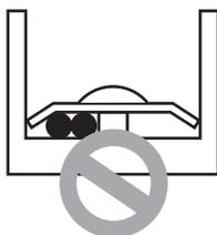
Запрещается подключать провода разной толщины.
