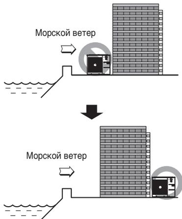
При необходимости установки наружного блока на стороне здания, обращенной к морю, установите перед блоком ветрозащитный экран.
