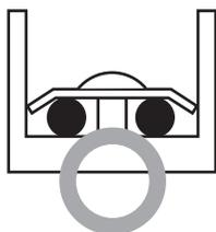
Запрещается соединять два провода к одной стороне.
