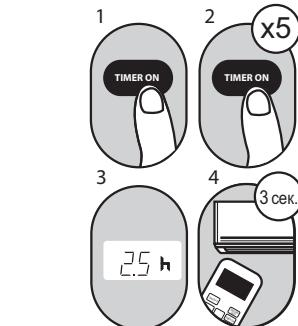
Пример: установка таймера на включение блока через 2,5 часа.
