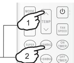
В режиме 8 °C HEAT температура по умолчанию установлена на 8 °C. Режим 8 °C HEAT может быть установлен только тогда, когда кондиционер работает в режиме обогрева.
