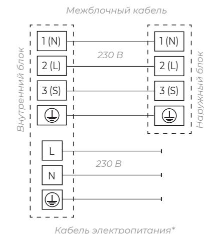
\* Кабель электропитания подключен к плате управления внутреннего блока
