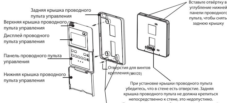
При установке проводного пульта необходимо отрегулировать нижнюю часть его панели относительно задней крышки, которую сначала нужно закрепить и только потом вставить другой конец панели проводного пульта.
