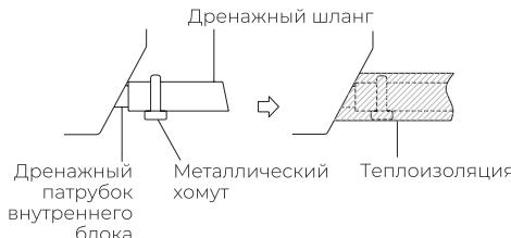
Установка блока без встроенной дренажной помпы
