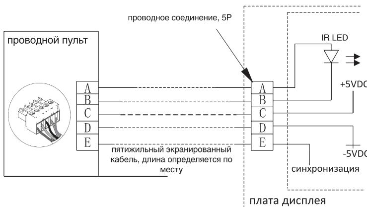
**Пояснение по монтажу:** при подключении проводного пульта используется кабель 5×0,5 мм<sup>2</sup>, без экрана. Максимальная длина кабеля не более 20 метров. Кабель подключается к модулю с одной стороны, с другой стороны к пульте.
