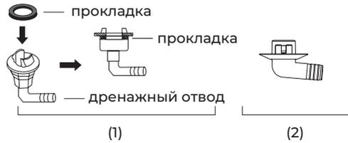
**Примечание:** изображение конструкции дренажного патрубка приведено для справки. Конструкция дренажного патрубка вашего кондиционера может отличаться (например, может отсутствовать резиновая прокладка).
