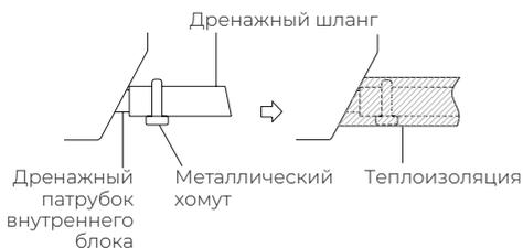
Установка блока без встроенной дренажной помпы
