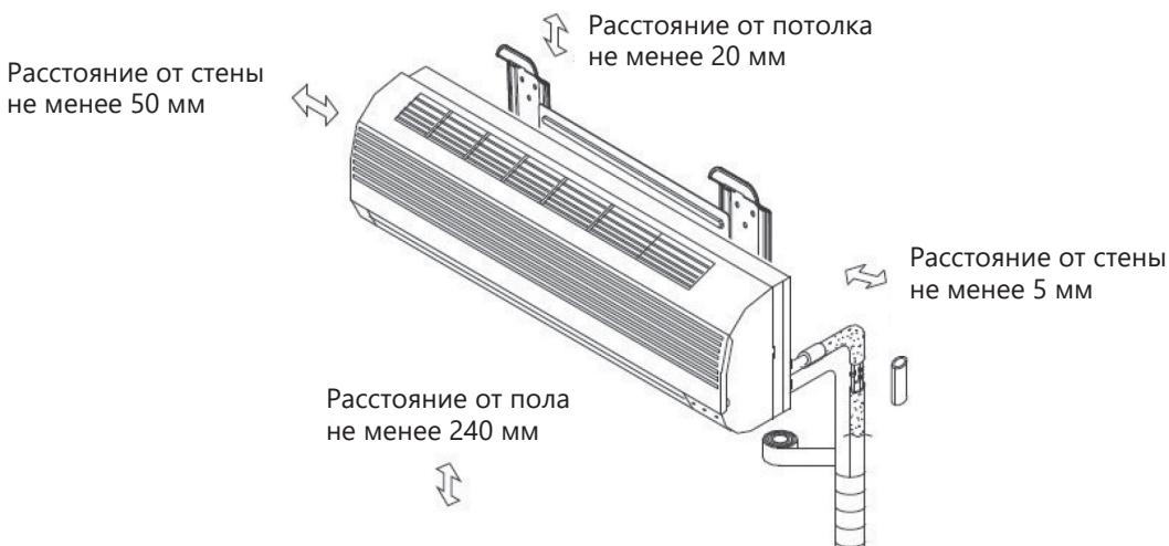
Поверхность стены, на которой устанавливается внутренний блок, должна быть гладкой и ровной, конструкция стены должна выдерживать нагрузку не менее 60 кг.
