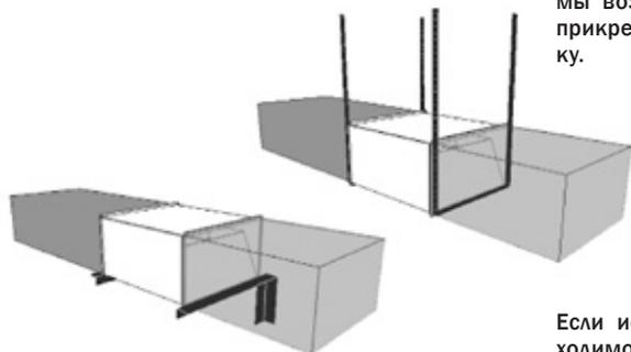
Если используются гибкие соединения, необходимо дополнительно прикрепить вентилятор к полу, стене или потолку.
