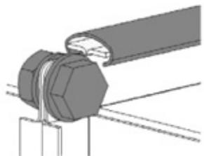
К воздуховодам вентилятор монтируется болтами и С-профилем.
