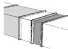
Для монтажа вентилятора рекомендуется использовать гибкие соединительные вставки, которые существенно сокращают передачу шума в воздуховод.
