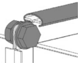
К воздуховодам вентилятор монтируется болтами и С-профилем.
