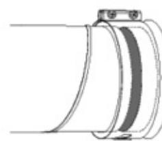
При использовании переходников рекомендуется использовать гибкие соединения круглого воздуховода.
