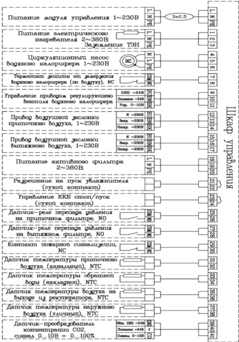
Схема ZPVP 450 HW, ZPVP 800 HW
